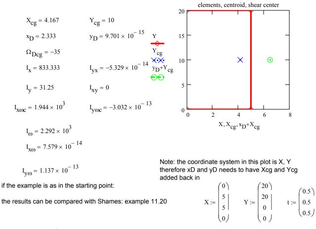
$$e = \frac{t_1 \cdot b^2}{2 \cdot b \cdot t_1 + t_2 \cdot \frac{h}{3}}$$
