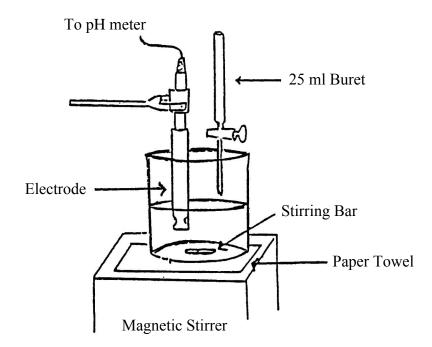
Fig. 3. Apparatus for Potentiometric Titration
